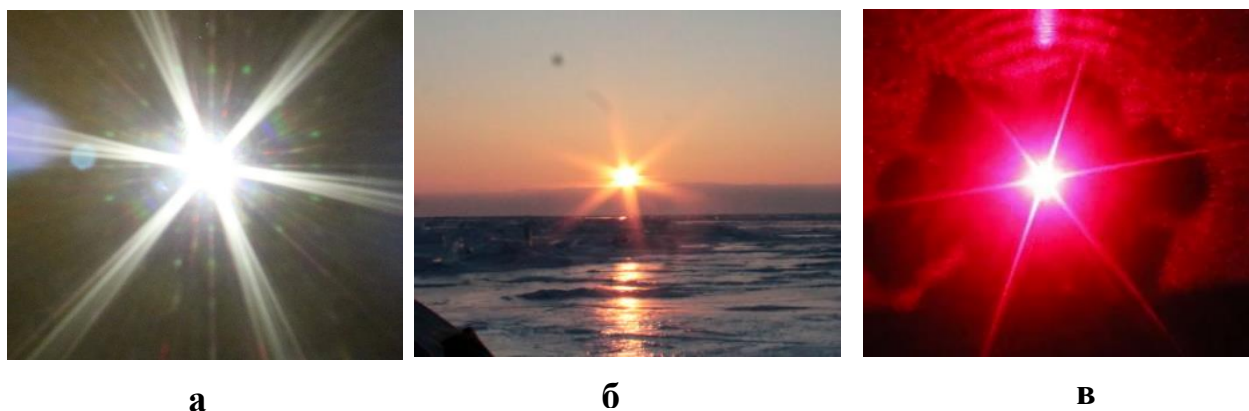
Рис. 2. а – Фотография светящегося светодиодного смартфонного фонарика; б – Солнце над зимним Байкалом; в – дифракционная картина от шестиугольного отверстия, сформированного из бритвенных лезвий и освещаемого лучом лазерной указки, на белом листе бумаги; сверху видны участки колец, получающихся в результате дифракции лазерного луча на выходном отверстии
