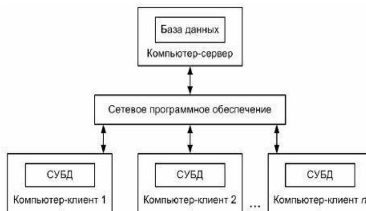
Рис. 1. Структура информационной системы с файл-сервером
