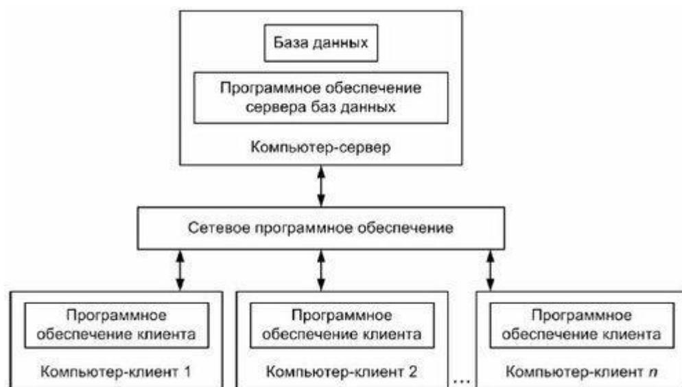
Рис. 2. Структура информационной системы с сервером базы данных
