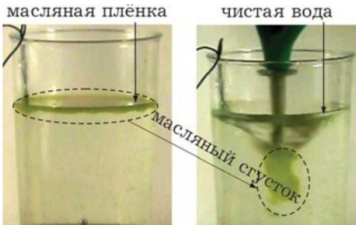
1 – масляная плёнка на поверхности воды, 2 – образование масляного сгустка в основании вихревой воронки и способ его удаления
