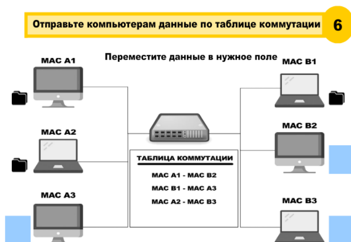
Рис. 1. Интерактивная модель «Принцип работы коммутатора» (проект на языке C#)
