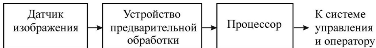
Рис. 1. Схема системы технического зрения
