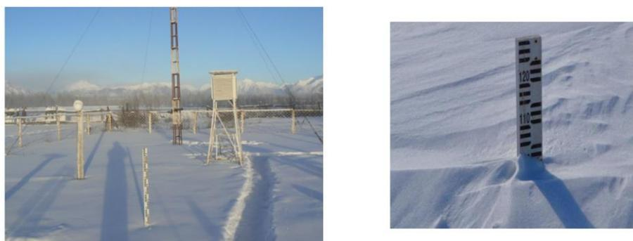
Рис. 21. Метеостанция и снегомерная линейка
