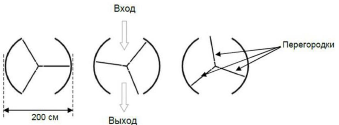
Рис. 18. Дверные перегородки
