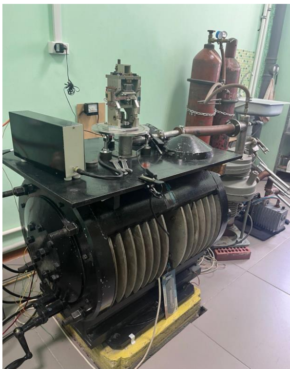
Рис. 5. Внешний вид и блок-схема установки для магнитной восприимчивости. 1 – маятниковые весы, 2 – титановый подвес с тиглем, 3 – система водяного охлаждения, 4 электромагнит с сердечником, 5 – вольтметр, 6 – трансформатор, 7 – выпрямитель, 8 – управляющие контакты, 9 – форвакуумный насос, 10 – вакуумный насос, 11 – нагреватель, 12 – термопара, 13 – понижающий трансформатор, 14 – трансформатор для регулировки, 15 – амперметр.
