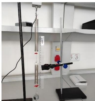
Рис. 11 - Последовательное соединение пружин
