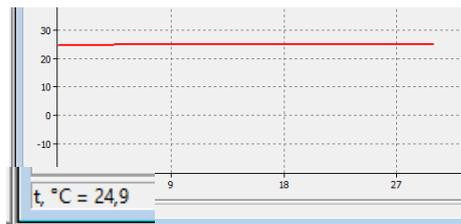
Рис. 22 - Измерение начальной температуры спирта
