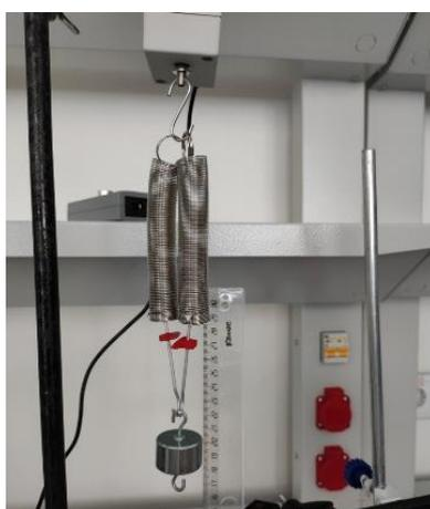
Рис. 12 - Параллельное соединение пружин
