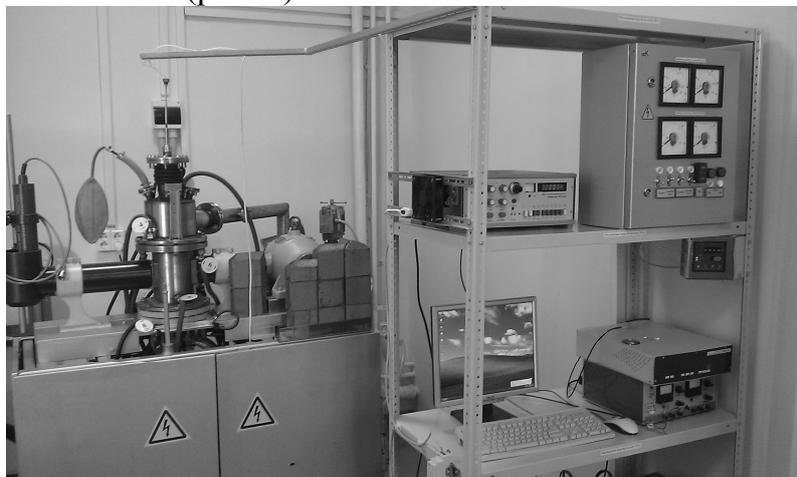
**Рис. 1.** Модернизированный гамма-плотномер.
