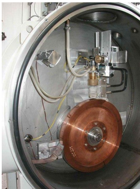
Рис. 3. Фотография установки для получения аморфной металлической ленты способом спиннингования.
