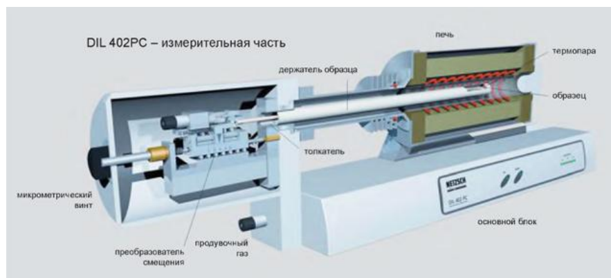
Рис. 4. Схема установки дилатометра.
